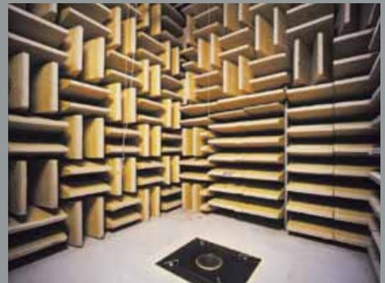
**Schalltote Messräume:** Die schallschluckenden unserer aufwändigen, schalltoten Messräume Innenwandauskleidungen absorbieren den Schall bei jeder Frequenz im Hörbereich. In einer solchen Messumgebung können unsere Techniker klangkritische Details im Verhalten eines Lautsprechers zuverlässig beurteilen, und zwar ungestört von jeglichen Umgebungsgeräuschen oder Schallreflexionen aus dem Hörraum.
